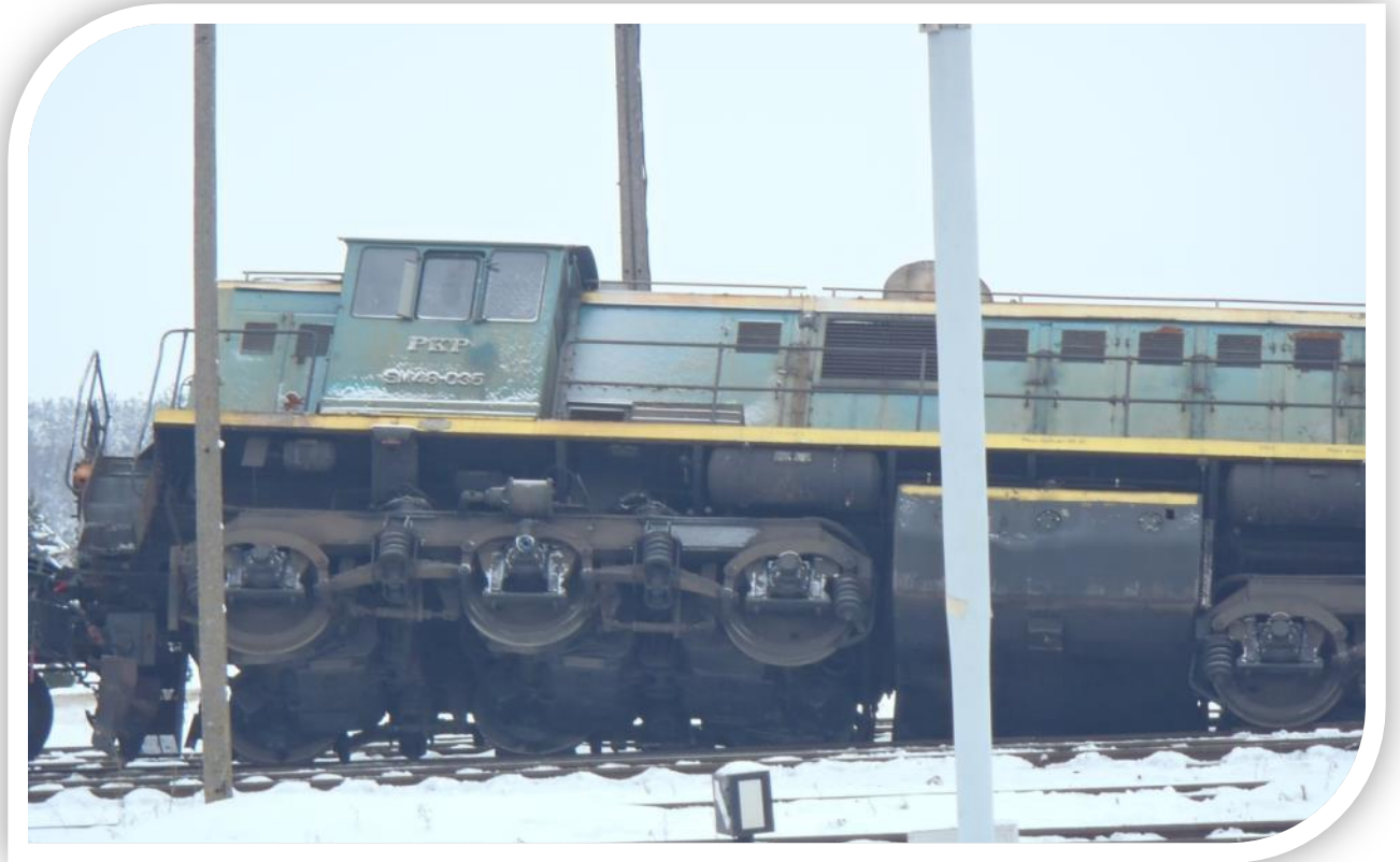
Wykolejenie na skutek kradzieży grzałek rozjazdów
