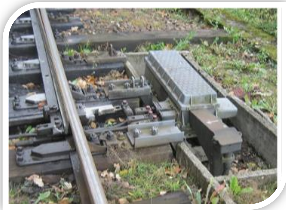
Elektryczny napęd zwrotnicowy zabudowany w torach
