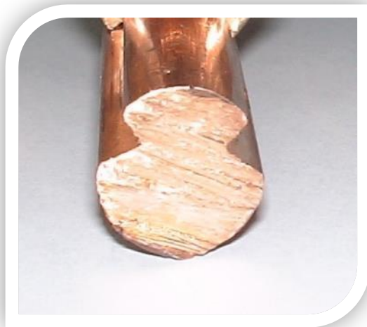
Drut jezdny profilowany – przekrój poprzeczny
